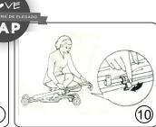
Enchanche el seguro lateral con el tubo de las ruedas delanteras.
