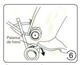
Para activar los frenos presione hacia abajo la palanca de freno ubicada entre el par de ruedas. Para desactivar los frenos tire hacia arriba la palanca.
