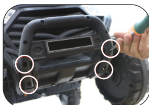
11. Ajuste los tornillos con el destornillador.
