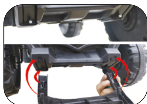
10. Retire los tornillos e instale el paragolpes.
