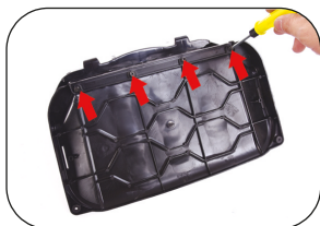
5.3 Ajuste con tornillos para dejar fijadas ambas partes.
