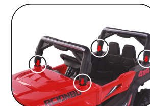
8. Instale las barandas en la parte trasera y delantera del auto. Presione hasta que quede correctamente colocado.
