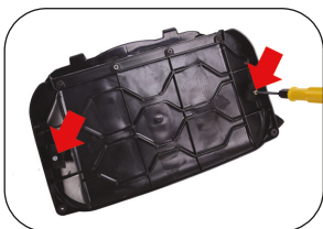
5.5 Fije el cinturón de seguridad en la parte inferior del asiento.
