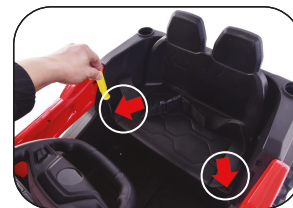
5.7 Coloque el asiento y ajústelo con los tornillos.
